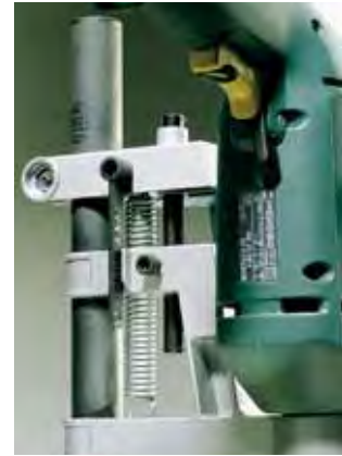
a furatmélységet a mélységállító állítja
