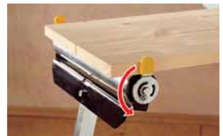
a hengeresgörgős alátámasztás lehetővé teszi a munkadarab feldolgozási irányban történő bevezetését
