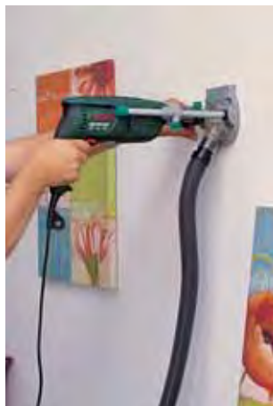
porszívócsatlakozóval a pormentes fúrásért minden körülmények között
