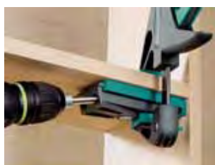
Az "Undercover Jig" készülékkel pontos furatot készít a munkadarabba...
