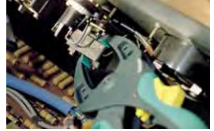
a hosszú, keskeny szorítókarok optimálisak még a szűkös helyeken is
