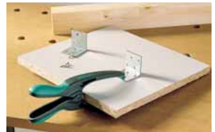
a nagy megfogási mélység biztosítja a munkadarab élettől távoli rögzítést
