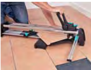
speciális vezetés a diagonális vágáshoz
